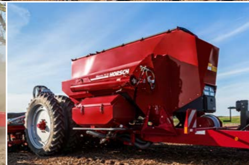
Säwagen mit 2 200 Liter Saatgut und 5 400 Liter Dünger
