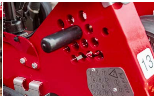
Lochbild zur Tiefeneinstellung mit 14 Stufen
