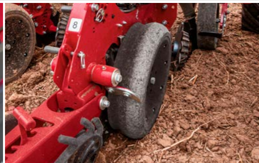
RID-Rad reduziert Bodenverdichtungen direkt am Säschlitz bei sehr harten oder Direktsaatbedingungen
