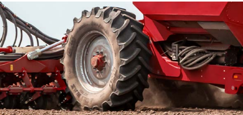
Bereifung 580/70 R 38 mit hohem Durchmesser und großer Aufstandsfläche
