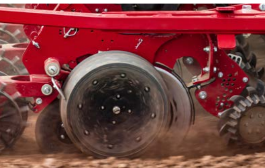
Schweres Doppelscheibensech mit verschleißbarmer, stabiler Tiefenführung
