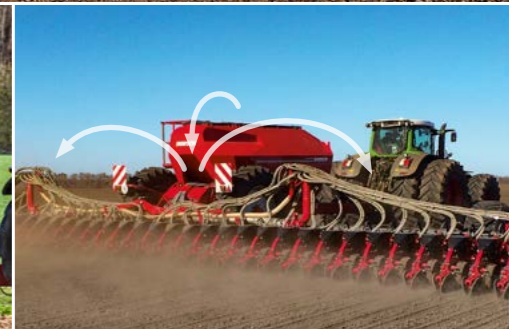
Übertragung des Säwagengewichtes auf die Säschiene für höheren Schardruck und Entlastung der Räder
