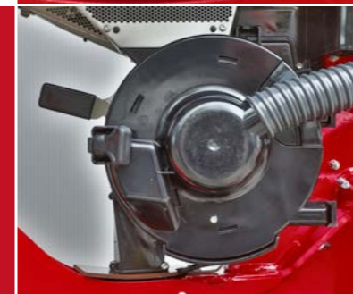
Gut zugänglicher Dosierer mit unterschiedlichen Dosierscheiben je nach Kulturart
