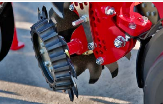
Optionale Räumsterne, schwimmend mit Tiefenführung
