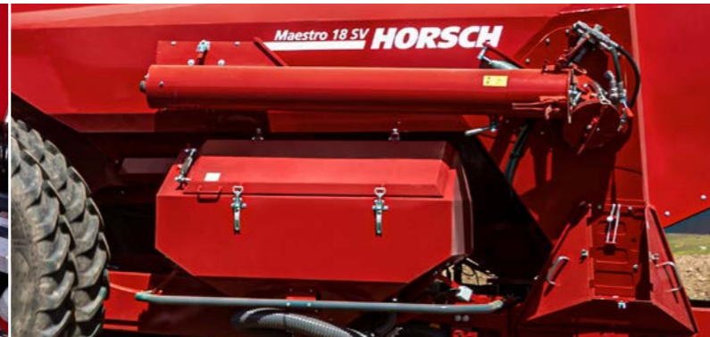
Befüllschnecke und zentrale Mikrogranulateinheit mit 400 bzw. 500 Liter Volumen
