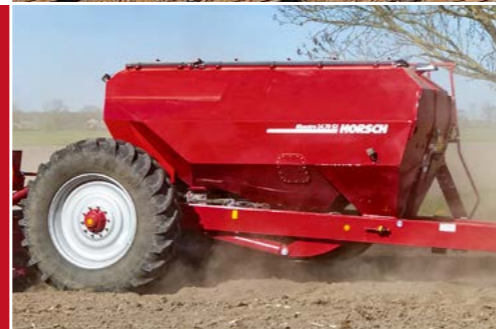
Säwagen mit 2 000 Liter Saatgut und 7 000 Liter Dünger für Maestro 24 SV/SX und 36 SV
