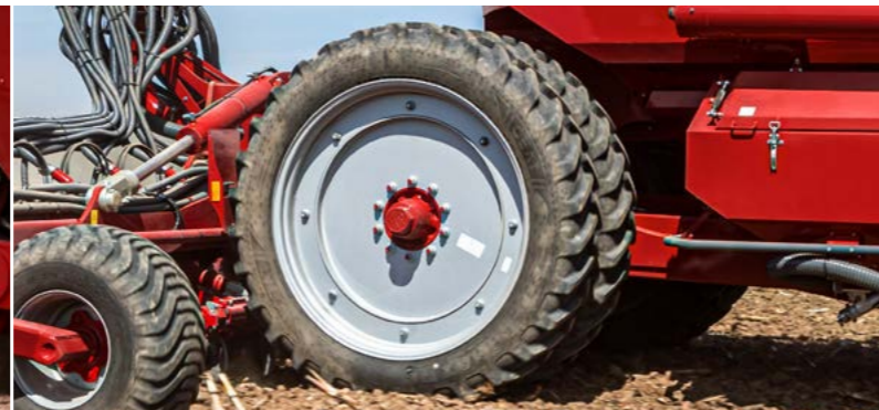
Zwillingsbereifung 300/95 R 46 für 45 cm und 50 cm Reihenabstand
